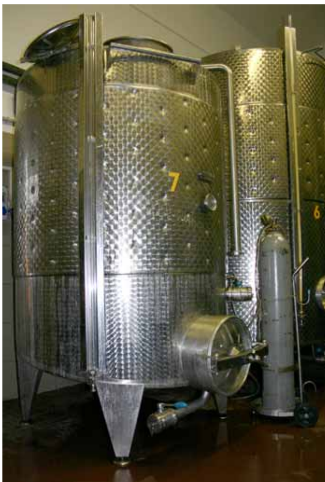
6. ábra: A kísérlet során használt kezelőtartály és a CO 2 palack, 2008
